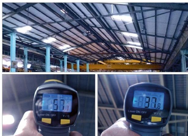
Telhado do pavilhão no interior (antes e depois): A temperatura foi baixada em 19,3°C. Benefícios: Melhoria das condições de trabalho, poupança de energia, redução de custos da manutenção do telhado.
