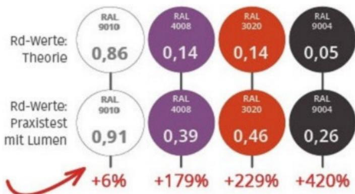
Das niederländische Unternehmen Meutzner Light Vision führte im April 2016 mehrere Messungen hinsichtlich diffuser Reflexionswerte (Rd), einschließlich des Lichtspektrums, durch.
