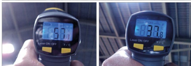
Střecha haly zevnitř (před–po realizaci): Teplota byla snížena o 19,3°C Přínos: zlepšení pracovních podmínek, úspora energie, snížení nákladů na údržbu střechy.
