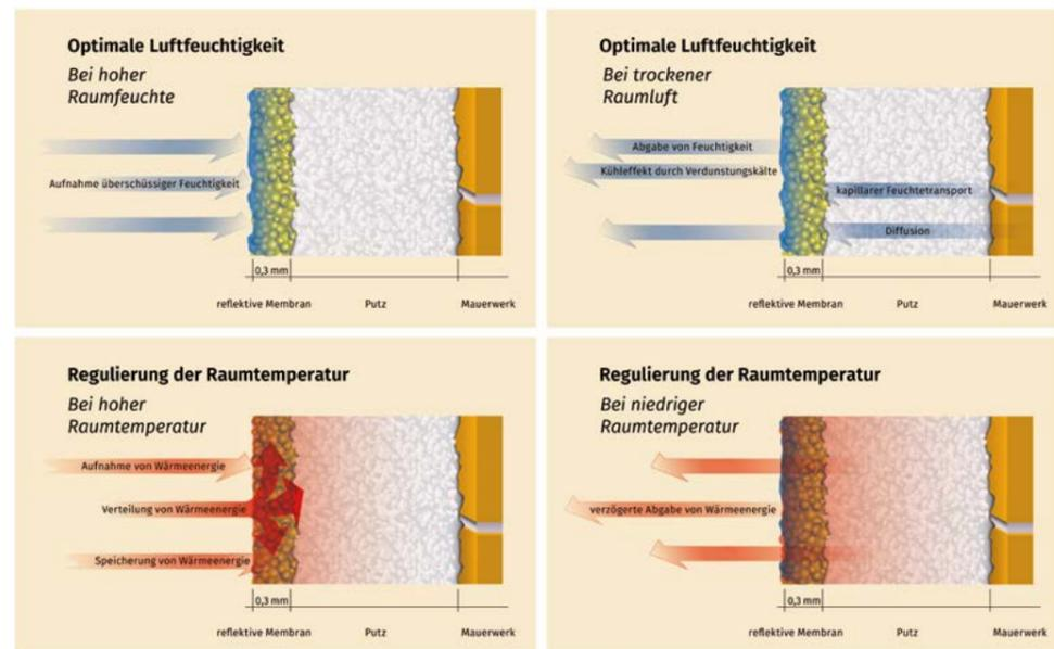
Das physikalische Wirkprinzip zur Regulierung von Luftfeuchte und Raumtemperatur für die Innenbeschichtung
